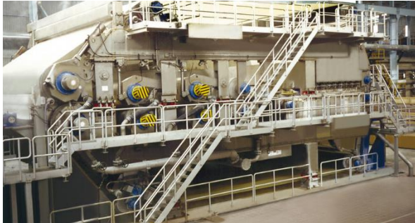
ANDRITZ-Doppelsiebpresse für die Zellstoffentwässerung
