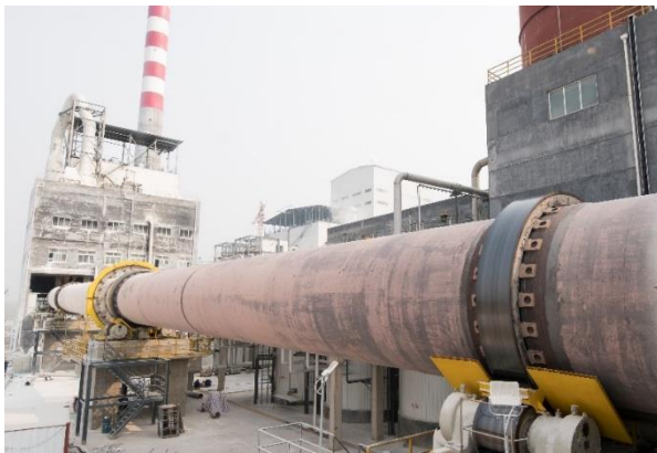
ANDRITZ LimeKiln-Drehrohröfen, der 2015 im Werk Shandong Sun Honghe in Zhoucheng, China, in Betrieb ging.
